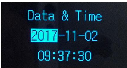
**[17.RTC Adj ]** – настройка точности хода часов. Задание коррекции хода часов за сутки. Для более точного определения коррекции необходимо настроить часы в соответствии с сигналами точного времени, проверить точность хода через десять дней в то же время, за сигналами точного времени того же источника. Полученный результат разделить на десять и это значение задать в этом пункте меню.
