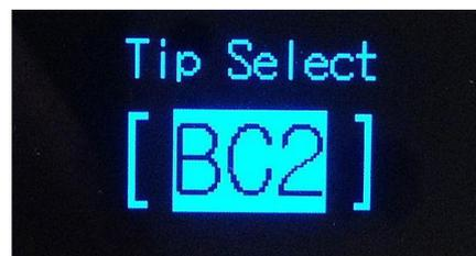
Путем вращения энкодера в ту или иную сторону выбираем тип картриджа T12, который фактически установлен в ручку паяльника.
