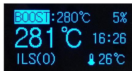
Поворот энкодера по часовой стрелке активирует «форсированный режим» с повышенной температурой жала. Вверху слева на индикаторе в этом режиме отображается надпись BOOST.
