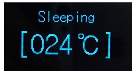
Из «режима ожидания», «режима сна» и «режима хранения экрана» достаточно просто выйти в «рабочий режим». Для этого надо кратковременно нажать на кнопку энкодера. При наличии датчика движение в ручке паяльника и соответствующих настройках меню **[01.Standby]** из «режима ожидания» и «режима хранения экрана», если он активировался во время действия «режима ожидания», в «рабочий режим», также можно выйти, подняв паяльник с подставки или сделав паяльником несколько движений.
