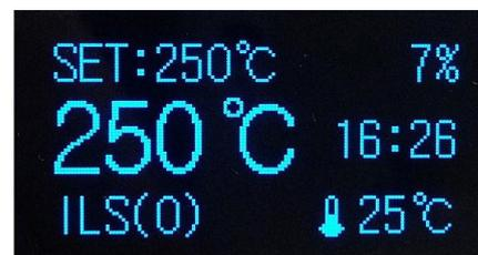
Выход в «рабочий режим» осуществляется автоматически по истечению времени, которое установлено в меню, а также вручную при кратковременном нажатии на кнопку энкодера или при повороте энкодера минимум на три позиции против часовой стрелки.
